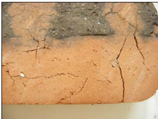
Fig. 35 : Présence d'un voile de terre et d'un voile blanc sur la céramique après nettoyage avec l'EDTA
