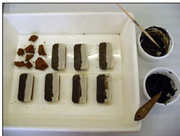
Fig. 32 : Application des la terre sur les éprouvettes
