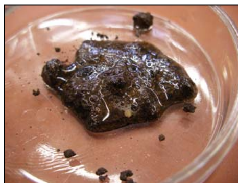
Fig. 1 : Effervescence des parties calcaires de la terre
