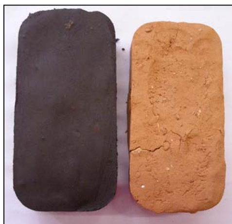
Fig. 6 : Retrait des éprouvettes après cuisson
