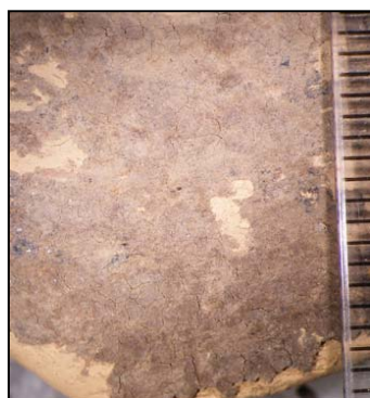
Fig. 25 et Fig. 26 : Rep.27-061 fine avant (à gauche) et après nettoyage à l'airbrush
