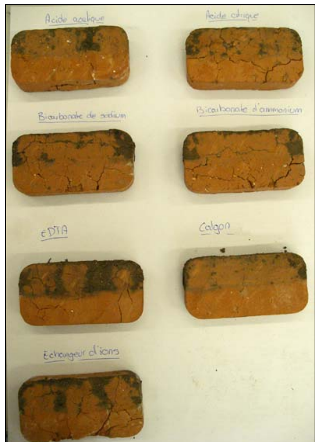
Fig. 37 : Eprouvettes de terre cuite après les tests de nettoyage
