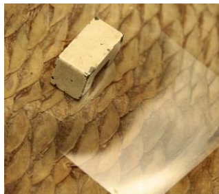
Photo 43 : Mélinex entre écaille et poids.
