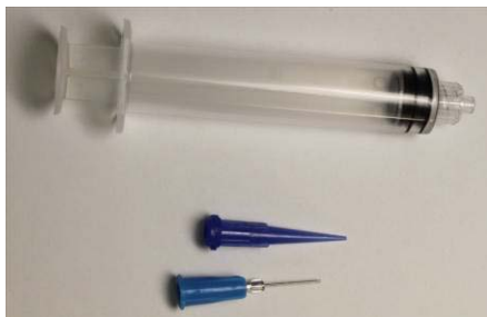
Photo 41 : Seringue et deux de ses embouts (Stouls Conservation). (©Paillier A.)
