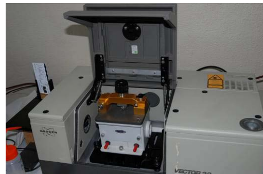
Photo 14 : Application d'une forte pression sur l'échantillon en poudre (de l'ordre de 1 à 2 kb) sous l'enclume.
