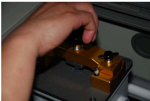
Photo 14 : Application d'une forte pression sur l'échantillon en poudre (de l'ordre de 1 à 2 kb) sous l'enclume.
