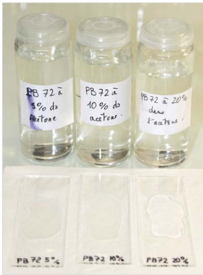
Photo 35 : contenants de Paraloid B72 (à 5-10-20%) et films respectifs sur lame porte-objet. (©Paillier A.)
