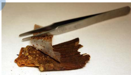
Photo 59 : Décollement du ruban à l'aide de la pince. (©Paillier A.)
