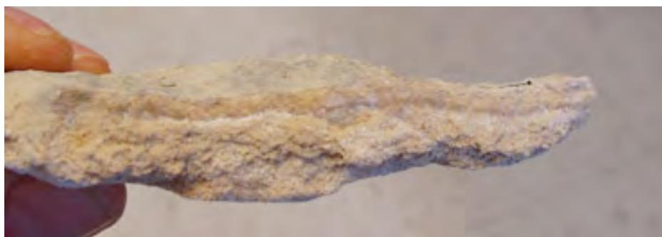
Photo 57: Profil d'un échantillon de roche montrant les lignes de couleur différente parallèles à la surface.
