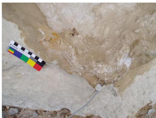
Photo 45: Sonde thermique °C 4 de la station "climat 2". La sonde est collée
