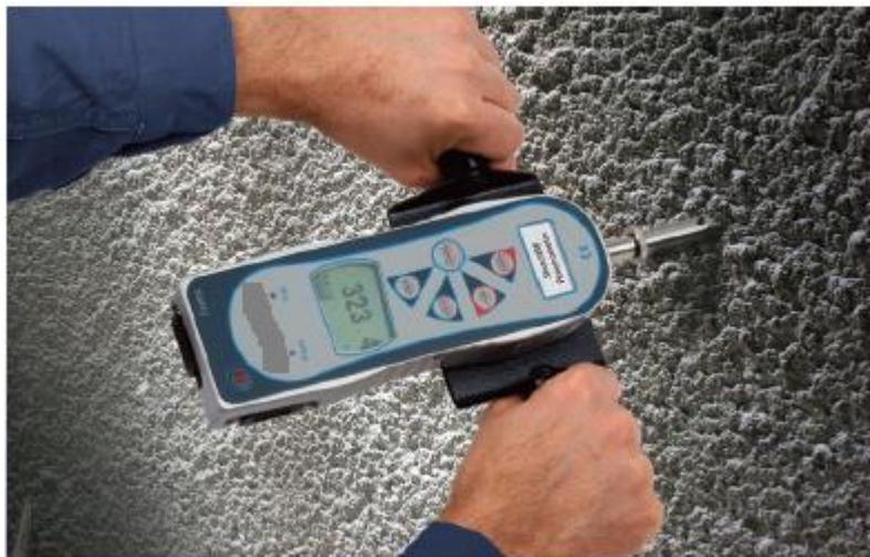
Figure 2. 16. Appareil de pénétration (méthode A) (Shotcrete Penetrometer, 2014)
