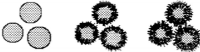
**Figure 2. 6.** Formation d'hydrates à la surface des granulats (**Acker, 1988**)
