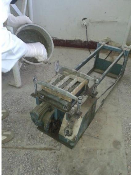
**Figure 3. 2.** Appareil à choc (photo prise par les auteurs)
