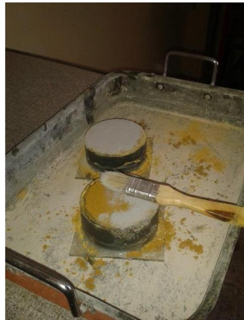
**Figure 3. 8.** Lissage de la surface et saupoudrage du démoulant (Photos prises par les auteurs)
