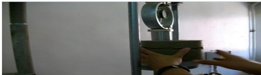
Photo 2.6 : Prise d'échantillon à partir d'une éprouvette compactée.
