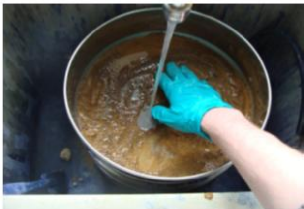
Photo 2.7 : Lavage du sol analysé au tamis de 80µm
