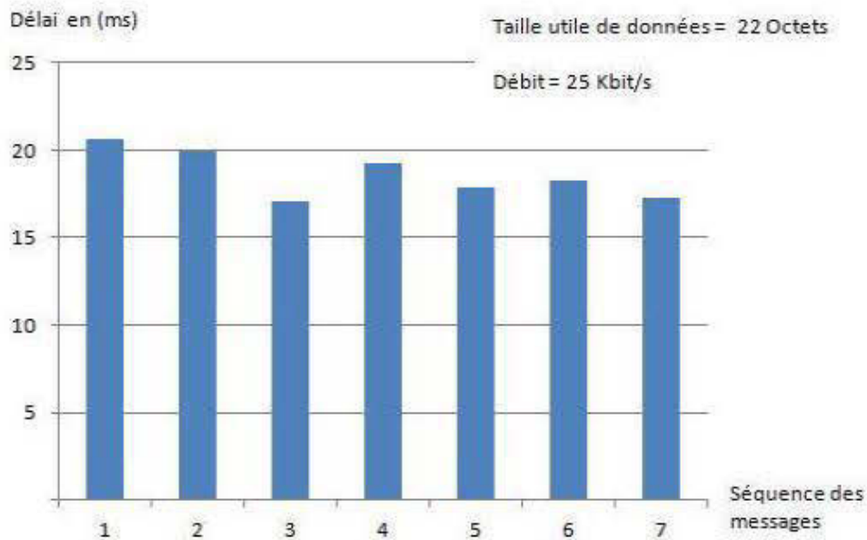
Figure 5. 10 : Délai de traitement au niveau de l'USRP avec un débit de 25 Kbit/s et une taille de messages de 22 octets
