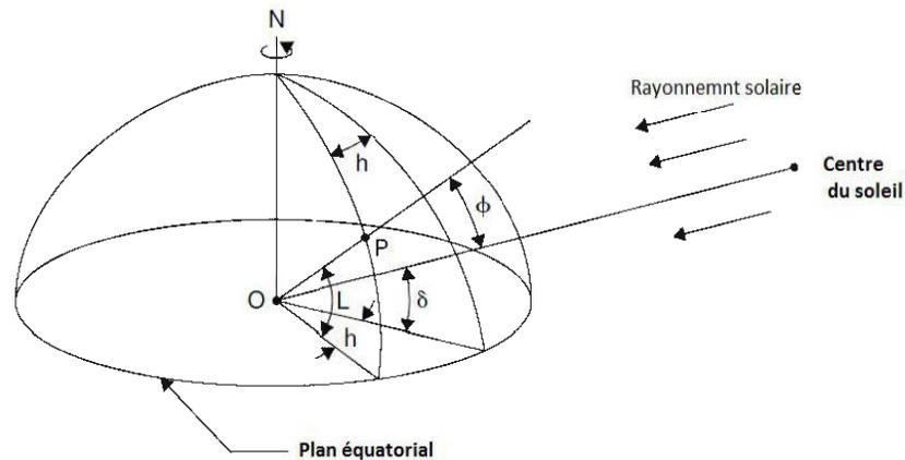
**Figure 5** : Paramètres géométriques du rayonnement incident
