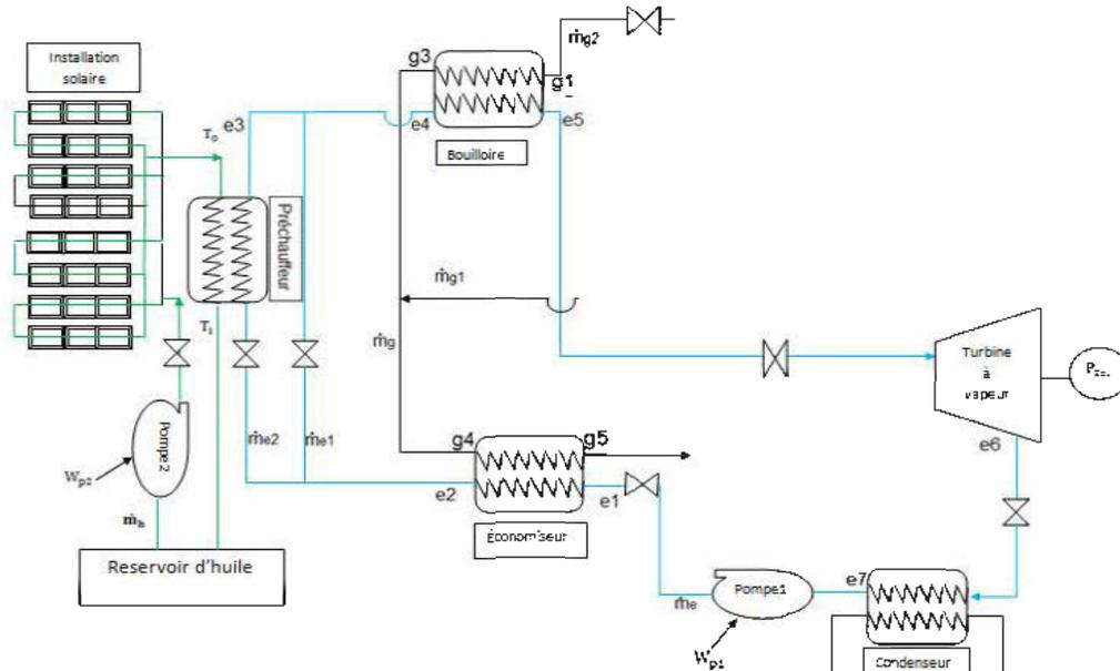
**Figure 8 :** Schéma de l'installation du cycle à vapeur
