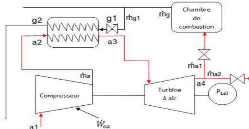
**Figure 6 :** Schéma du système turbine à air chaud
