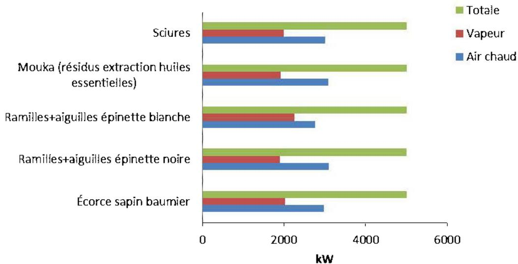
**Figure 45 :** Répartition de la production électrique pour différents types de biomasses
