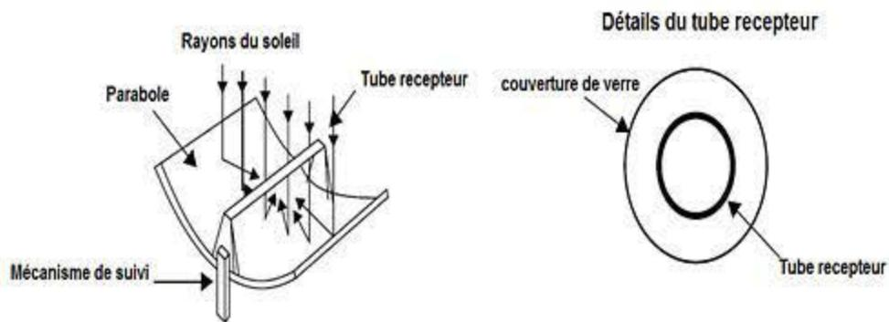
**Figure 1 :** Collecteur solaire cylindro-parabolique [11]
