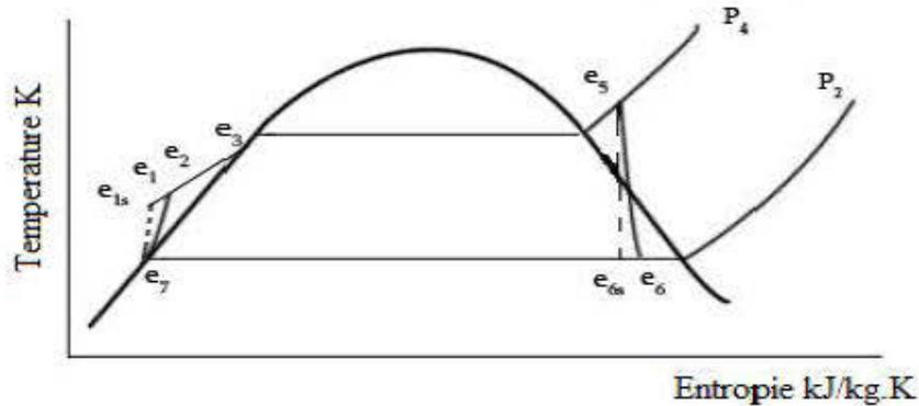
**Figure 9** : Cycle thermodynamique du cycle à vapeur
