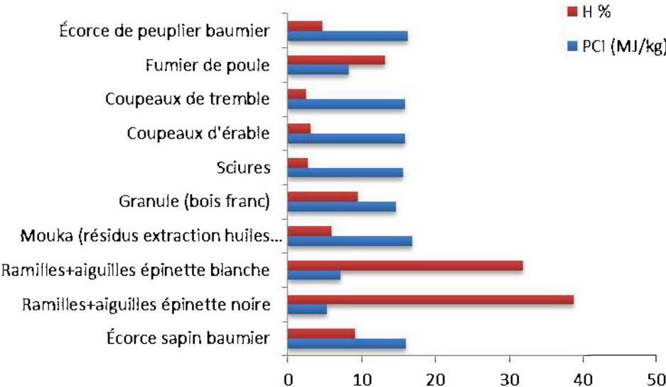
**Figure 13 :** Pouvoir calorifique en fonction du taux d'humidité
