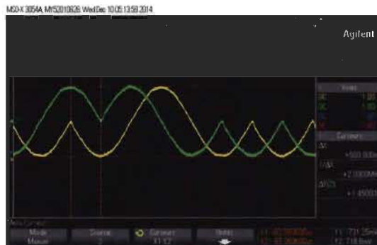
Figure 4.29 : Les sorties du CNA avec une fréquence de 50 MHz
