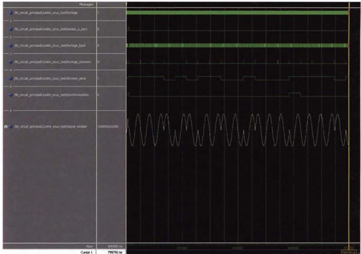
Figure D.22 : Résultats obtenus du modulateur BPSK
