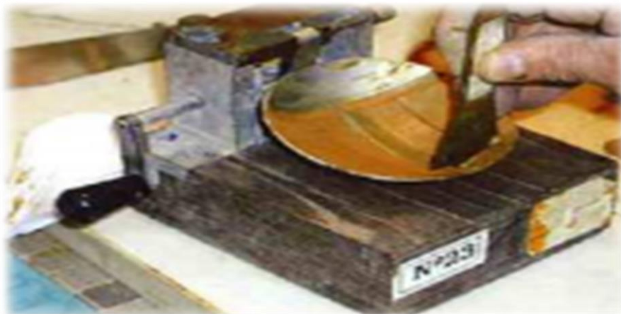
Figure 10 : Essai de limite de liquidité (Cité par : ROBERT ; 2011-2012)
