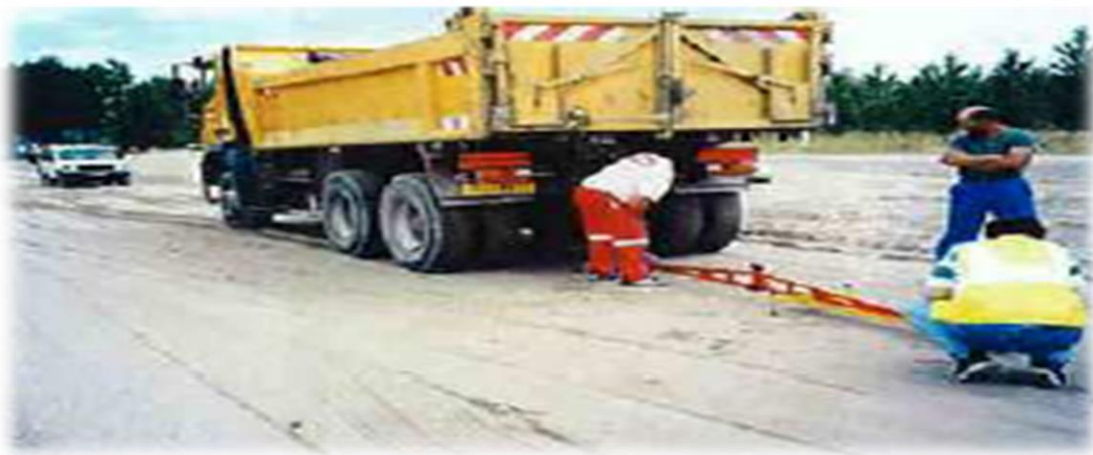
Figure 33 : Essai à la plaque (Cité par : FRED et OLIVIER ; 2011)
