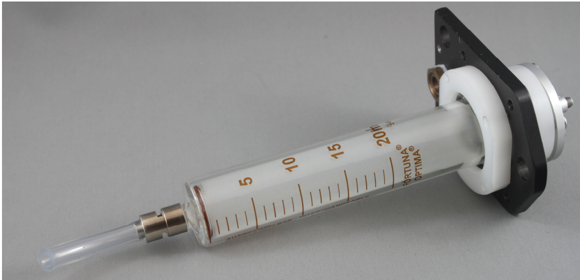
Figure 4.2 : Sous assemblage de la seringue permettant l'aspiration du sirop.
