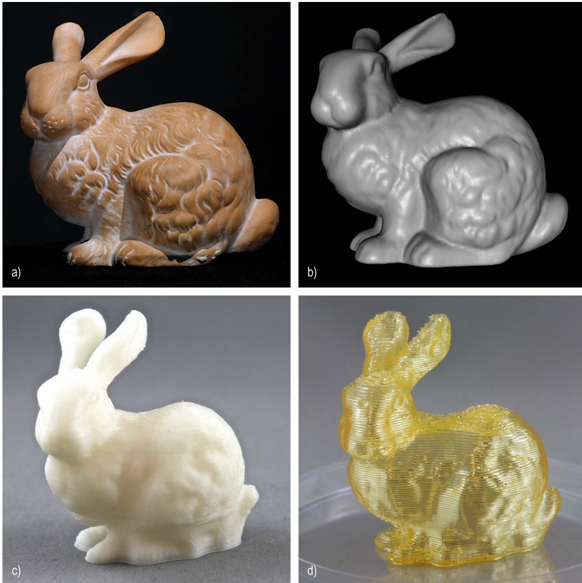
Figure 6.1 : a) Photo du lapin de Stanford original (une gracieuseté du Stanford Computer Graphics Laboratory [55]). b) Rendu du fichier numérique une fois scanné [55]. c) Impression du lapin de Stanford en ABS à l'aide d'une imprimante Airwolf3D XL. d) Impression du lapin de Stanford en sucre vitrifié.
