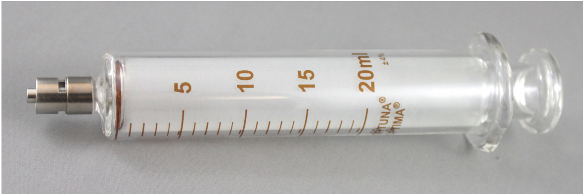
Figure 3.2 : Seringue de verre Poulten & Graf GmbH de 20 ml utilisée comme réservoir pour le sucre vitrifié.
