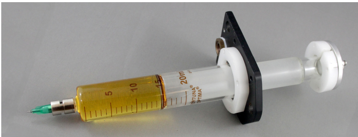
Figure 4.3 : Sous-assemblage de la seringue après l'aspiration du sirop.
