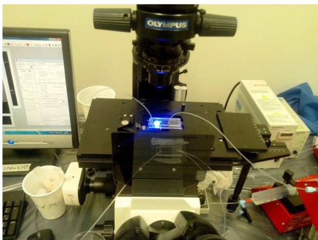
Figure 25 : Montage pour la surveillance du relargage de la fluorescéine des MSNs.
