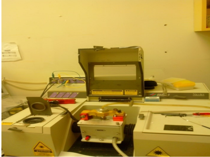
Figure 13 : Le spectromètre FTIR avec l'accessoire ATR diamant.
