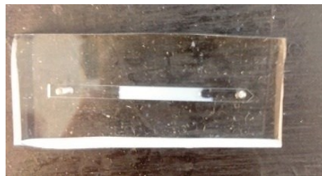
Figure 21 : Suspension de MSNs positionnée au milieu du microcanal en PDMS après un traitement par un liquide de la vaisselle (#MS0500424, Canada).
