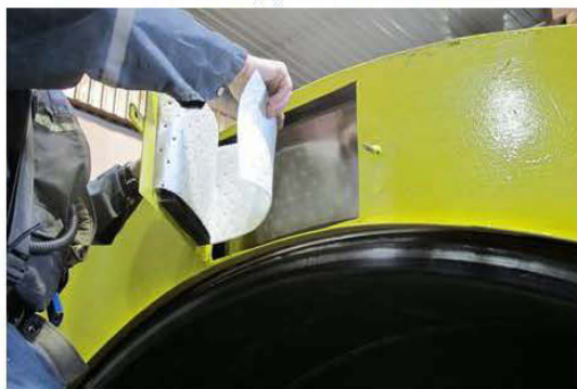
Mise en place d'un mécanisme pour nettoyer les disques des freins
