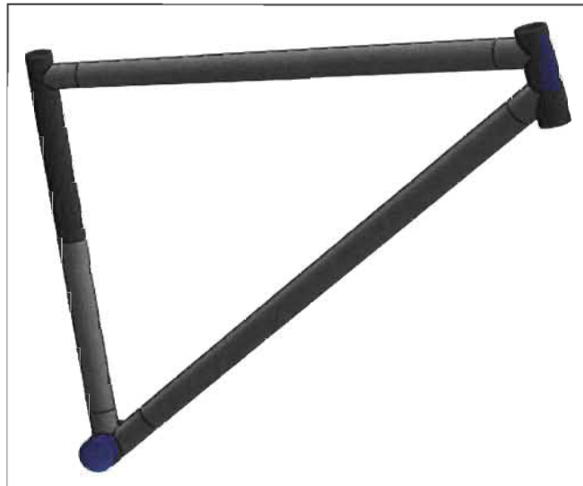
Figure 2.10 Zones de non-design (en bleu) du triangle avant d'un cadre de vélo
