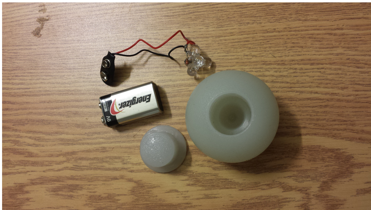
Figure 17 : Boule de silicone accompagnée de DEL infrarouges (photo par l'auteur). 2015.
