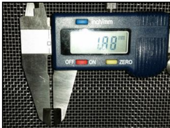
Figure-A-I-10 Dimension des filtres redresseur de la soufflerie Price-Paidoussis ( d=0.4\text{mm} et w=1.88\text{mm} )
