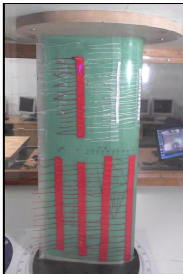
Figure 4.3 Aile rigide ATR42 au profil optimisé Tableau 4.3 Position x/c en pourcentage de corde des ports de pression de l'ATR42 optimisée
