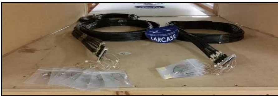
Figure 3.19 Assemblage final des capteurs Kulite aux câbles blindés
