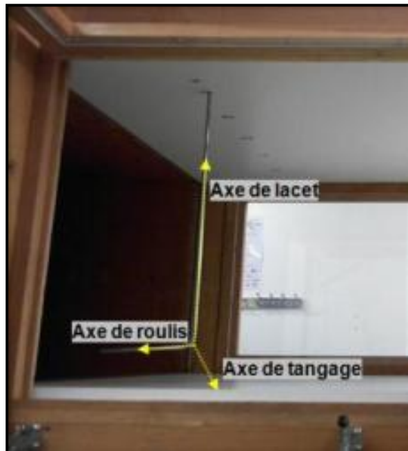
Figure-A-I-14 Degrés de mouvement du tube de Pitot
