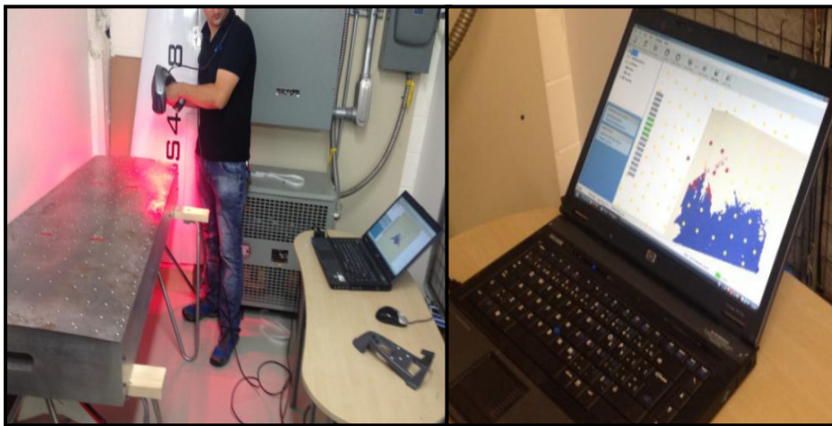
Figure 4.8 Création en temps réel du dessin 3D de l'aile métallique numérisée
