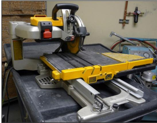
Figure 1.17 : Scie abrasive
