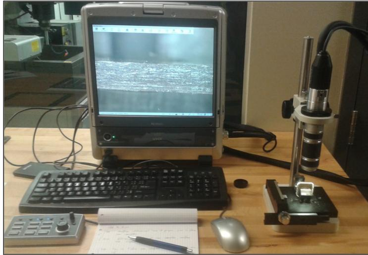
Figure 2.41 : Montage d'analyse de la surface usinée
