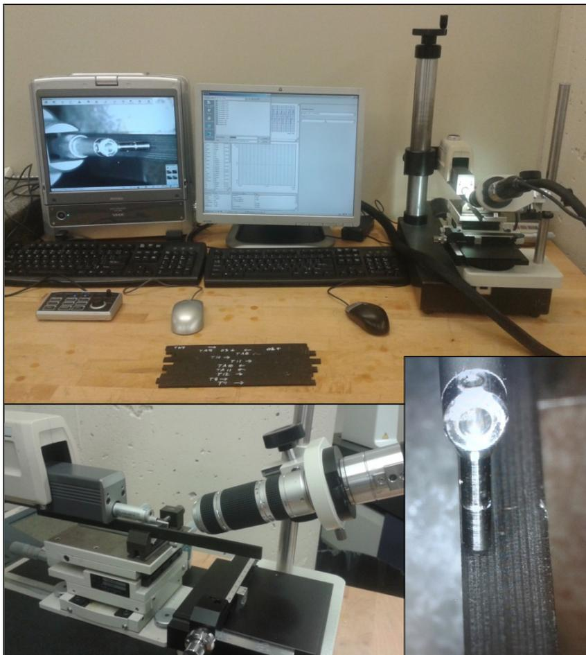
Figure 1.22 : Mesure de rugosité
