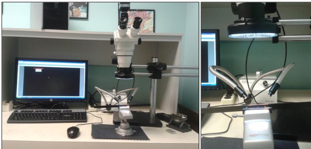
Figure 1.21 : Analyse de la surface usinée
