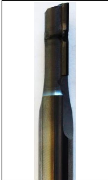
Figure 2.32 : Outil avec plaquettes diamant PCD
