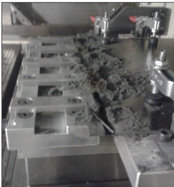
Figure 1.28 : Copeau sous forme de pâte
