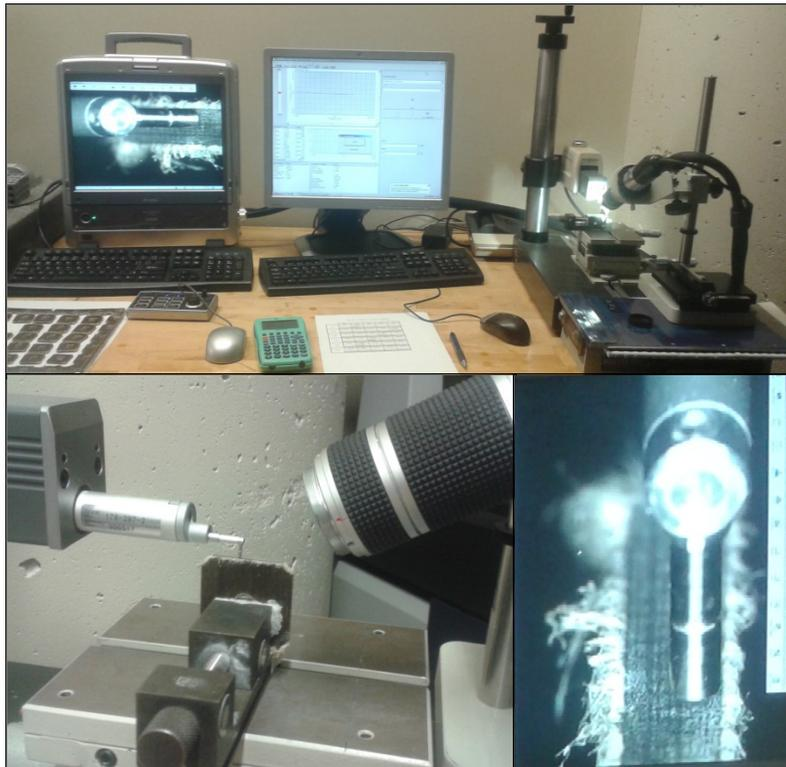
Figure 2.42 : Montage de mesure de rugosité
