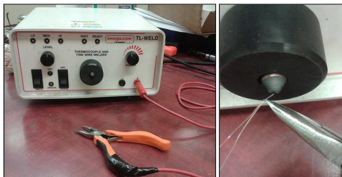
Figure 1.18 : Poste à soudé et soudure du thermocouple
