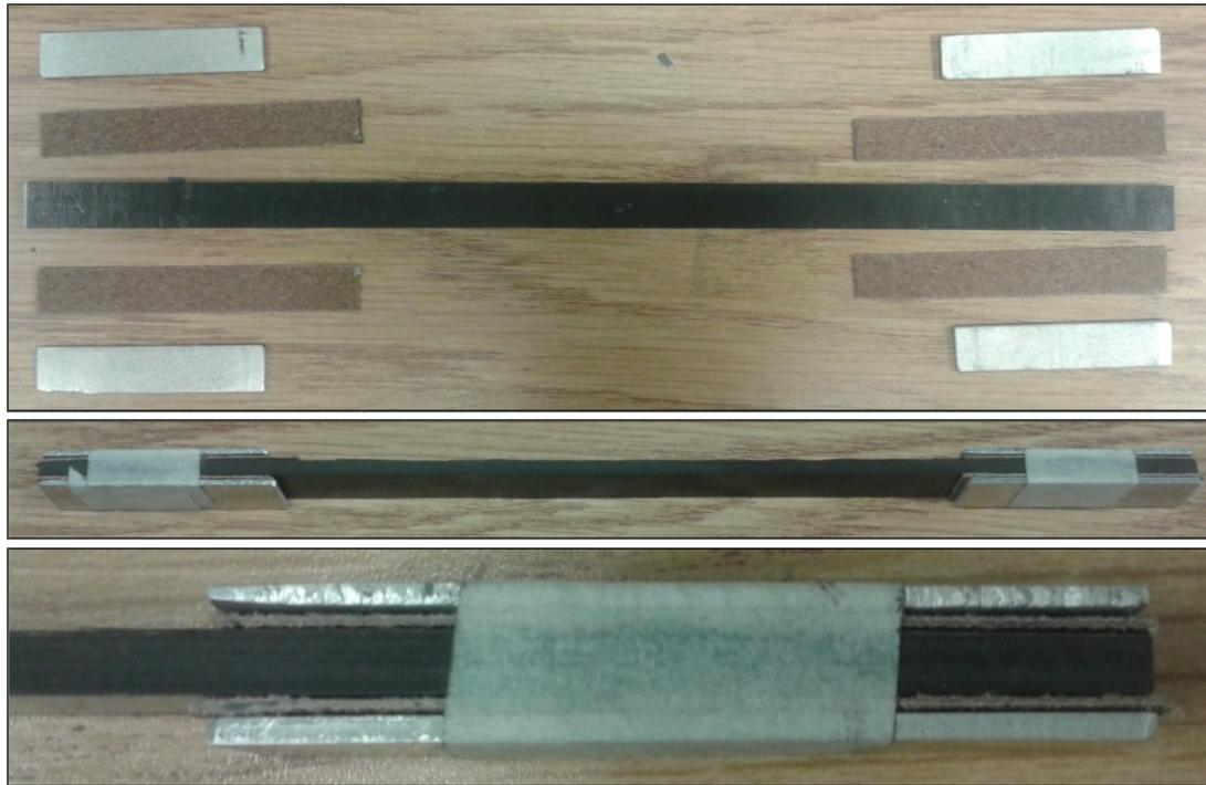
Figure 1.24 : Éprouvette de traction
