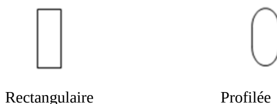
Figure 5.25. Différentes formes des briques entretoises
