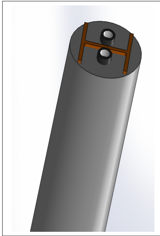
Figure 3.1 Modèle du pieu simulé dans Pilesim
