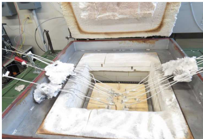
Figure 3.11 : Montage complet pour la mesure de la résistivité électrique pendant la cuisson des anodes.
