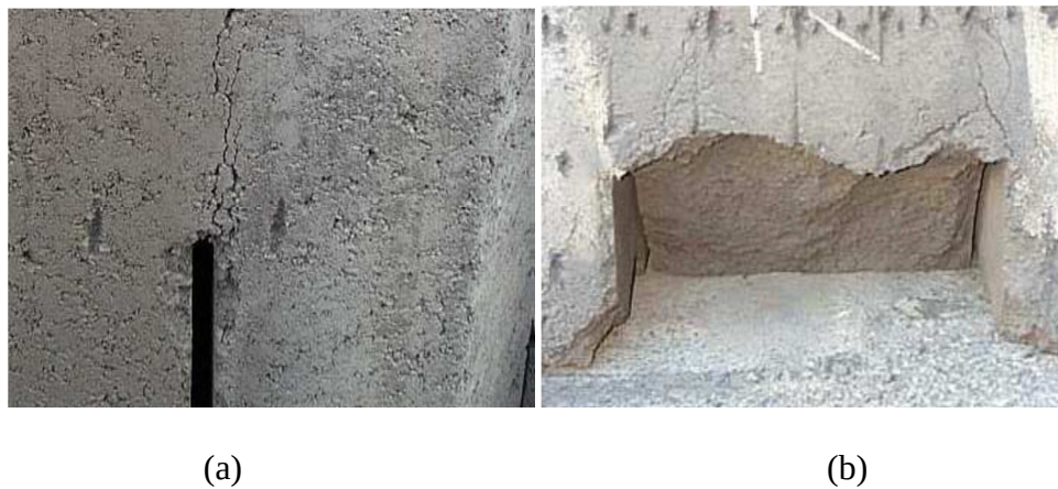
Figure 2.16 : Effet des rainures sur la fissuration des anodes. a) anode crue, b) anode cuite [106].
