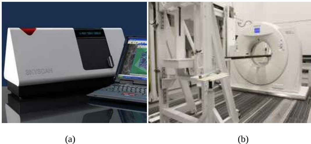
Figure 3.4 : Appareils tomographiques utilisés : (a) analyse des petits échantillons, (b) analyse des anodes de laboratoire.
