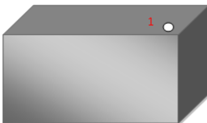
Figure 5.3 : Position du point de mesure de la température de refroidissement d'une anode crue, 1 : côté droit de l'anode.
