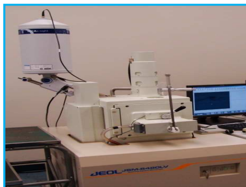
Figure 3.3 : Appareil de microscopie électronique à balayage utilisé pour la caractérisation de la fissuration dans des échantillons d'anodes cuites.
