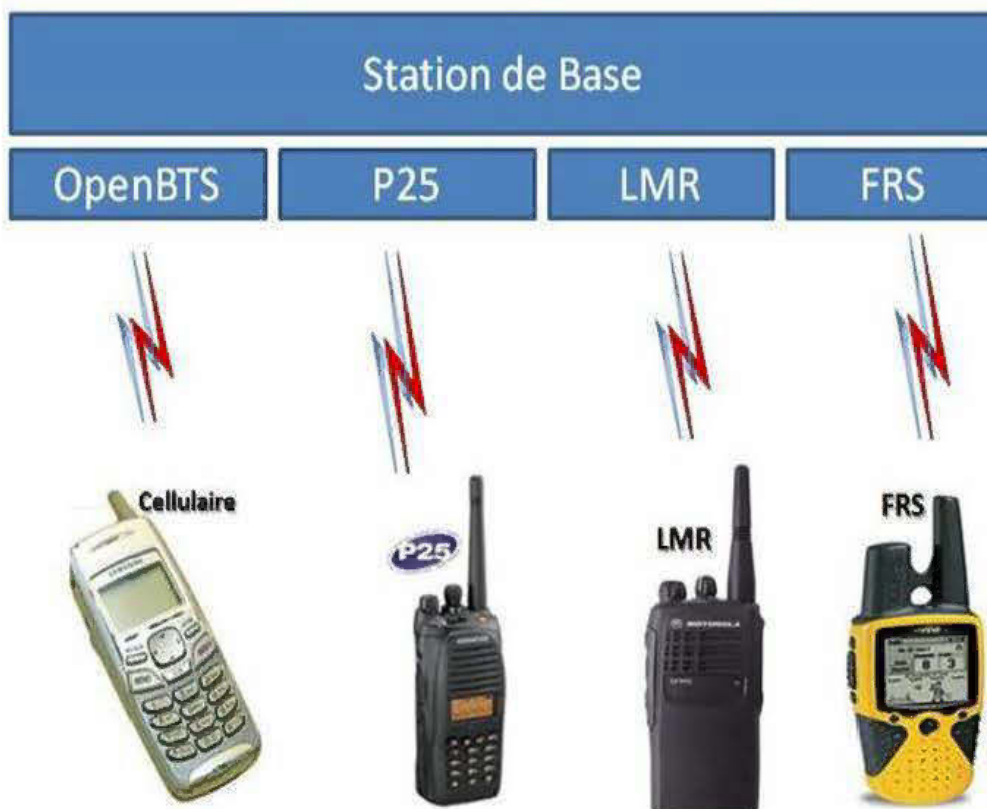
Figure 3.1: Schéma global de la station de base proposée
