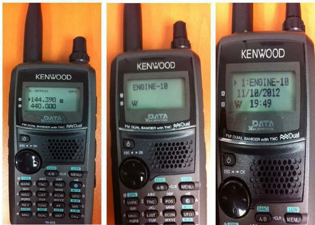
Figure 5.7 : Message reçu par le radio TH-D72A
