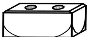
Figure 1.4 : Fissurations sur les côtés [18].
