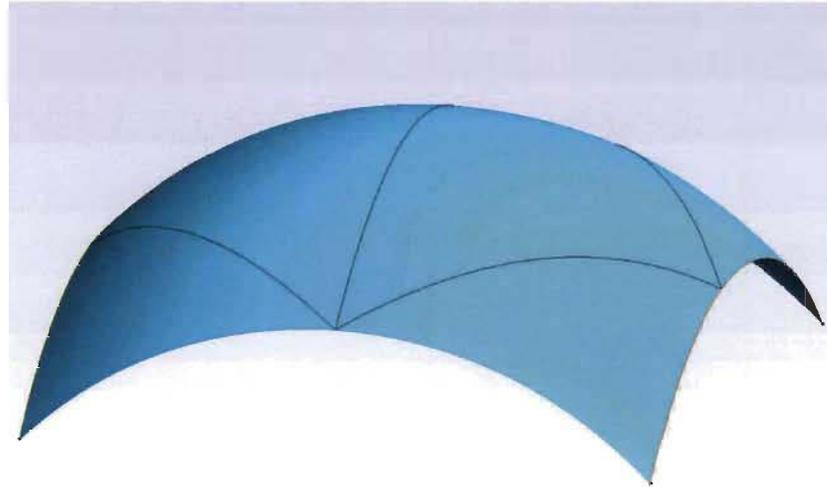
Figure 3.11 Coque maillée avec six éléments
