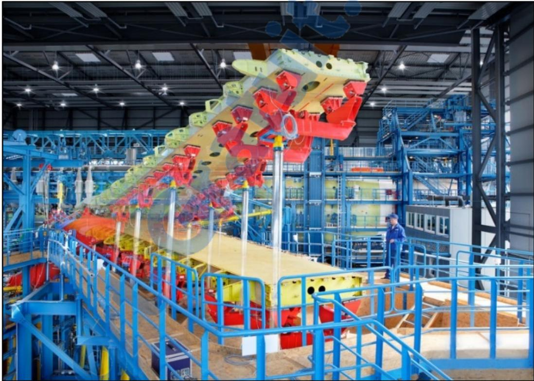
Figure 2.12 Test en fatigue du caisson de voilure de l'aile de l'Airbus A380
