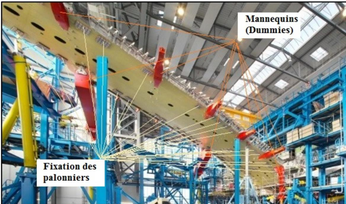
Figure 2.16 Essai à pleine échelle de l'A380 pendant son montage sur le banc d'essai
