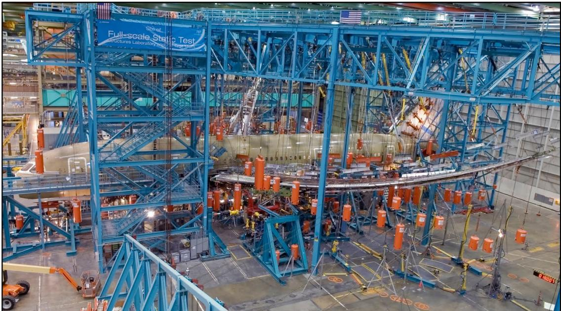
Figure 2.7 Test pleine échelle du Boeing 747-Dreamliner à l'ultime +2.5g
