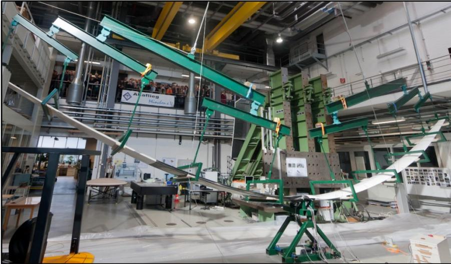
Figure 2.10 Test statique sur toute l'envergure de la voilure
