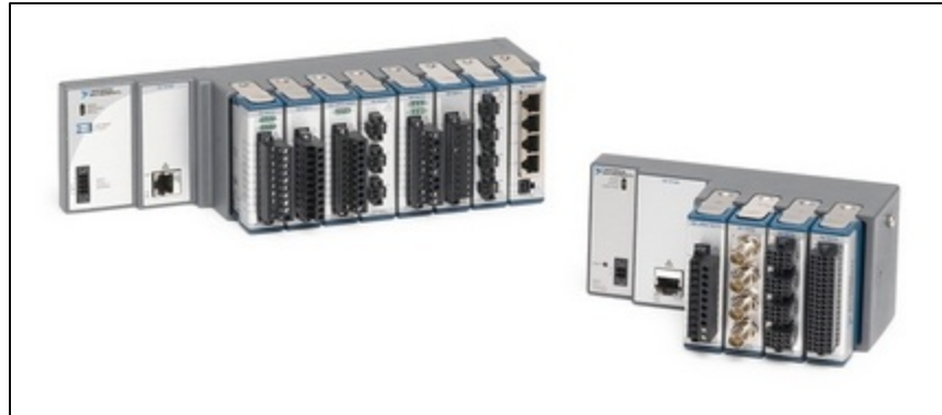
Figure 2.1 CompactRIO tirée de (NI CompactRIO)
