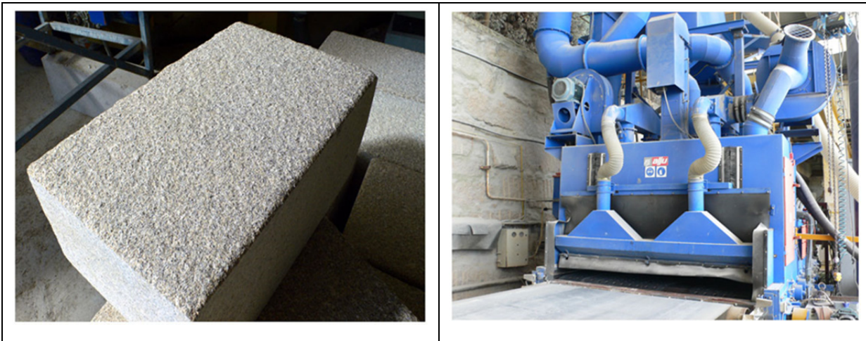
Figure 2.41 Obtention du fini grenailé Tirée de http://www.mochalgranit.com
