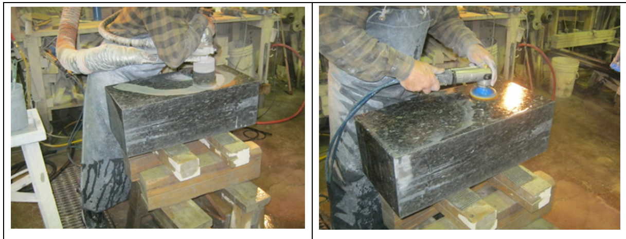
Figure 2.31 Polissage manuel sur une grande surface
