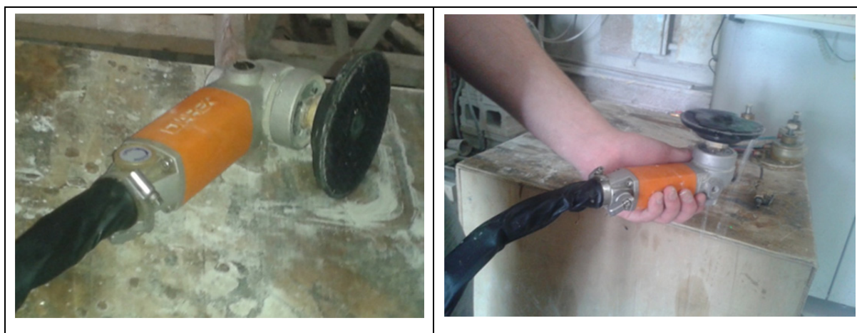
Figure 2.33 Outil pneumatique pour le polissage manuel
