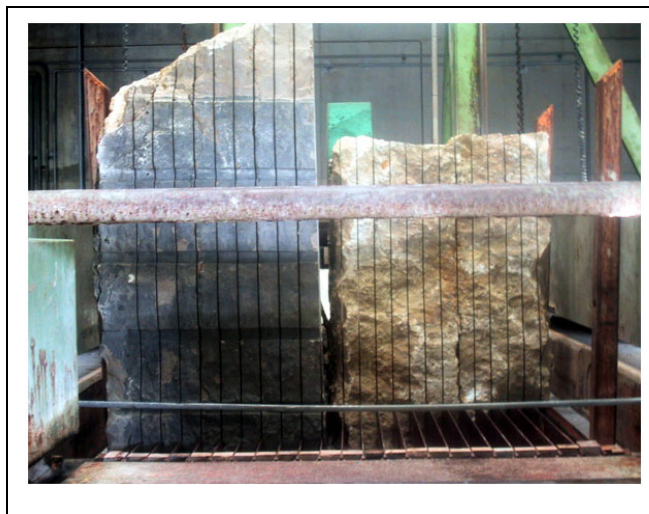
Figure 2.3 Sciage au châssis Tirée de http://www.mochalgranit.com
