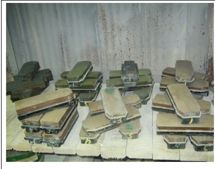
Figure 2.17 Outils de polissage pour polisseuse Polimatic
