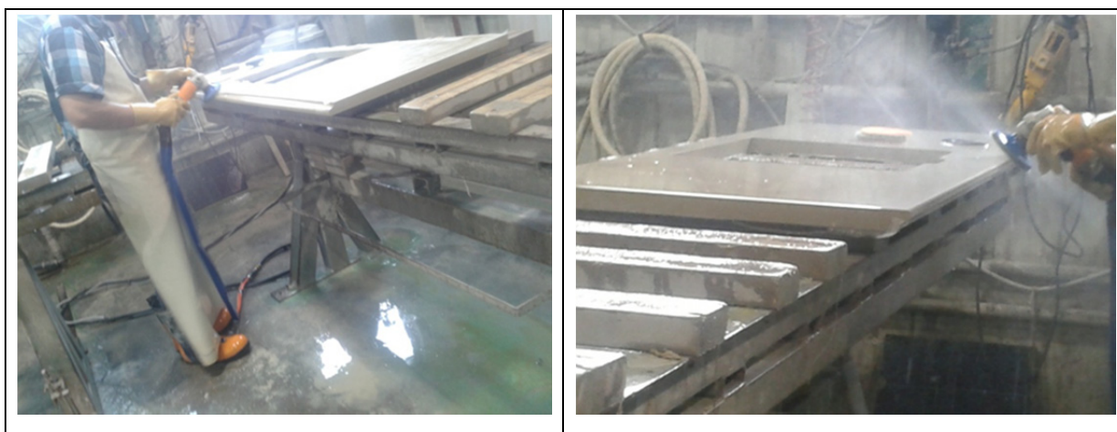
Figure 2.28 Polissage du contour extérieur
