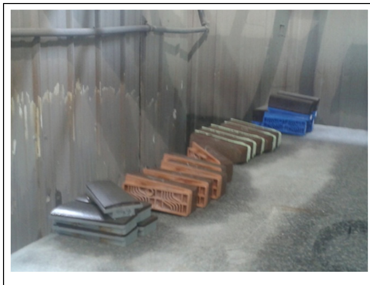
Figure 2.15 Outils de polissage pour polisseuse à broche unique
