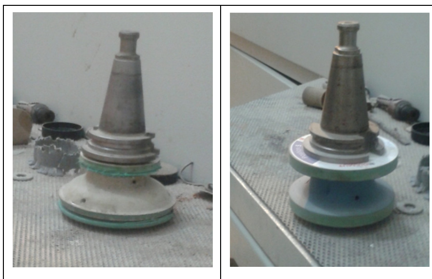
Figure 2.20 Outils de polissage pour contours intérieurs et extérieurs
