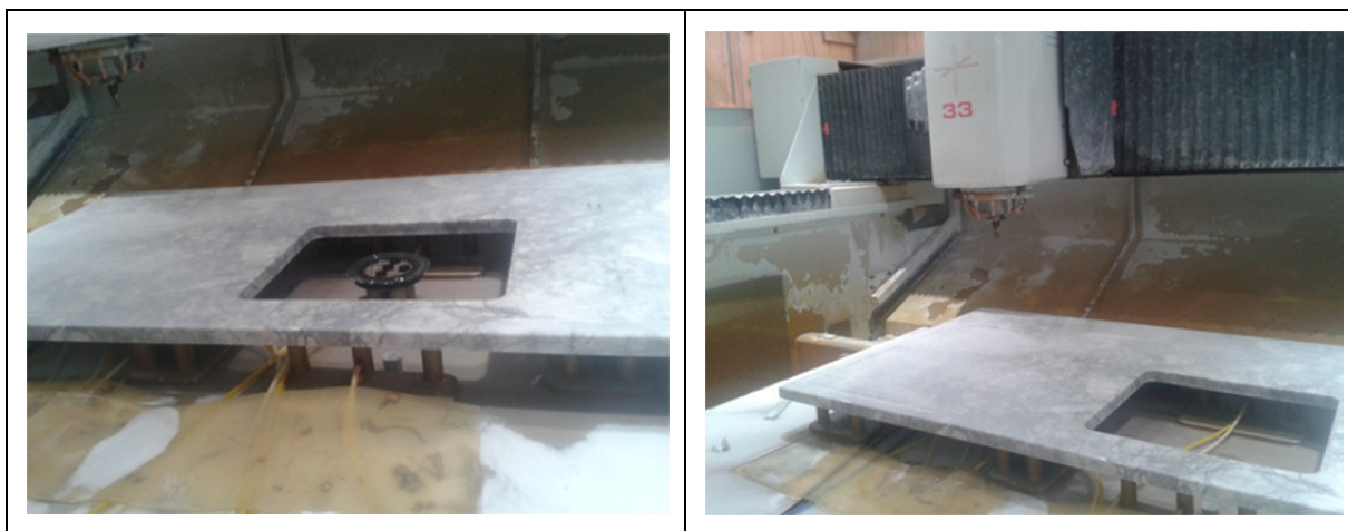
Figure 2.19 Polissage des contours intérieurs et extérieurs d'un comptoir
