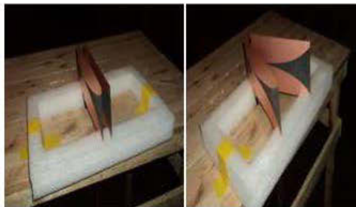
Fig. 4.2. Configuration du 2x2 MIMO-Vivaldi (a) MIMO-R (b) MIMO-A
