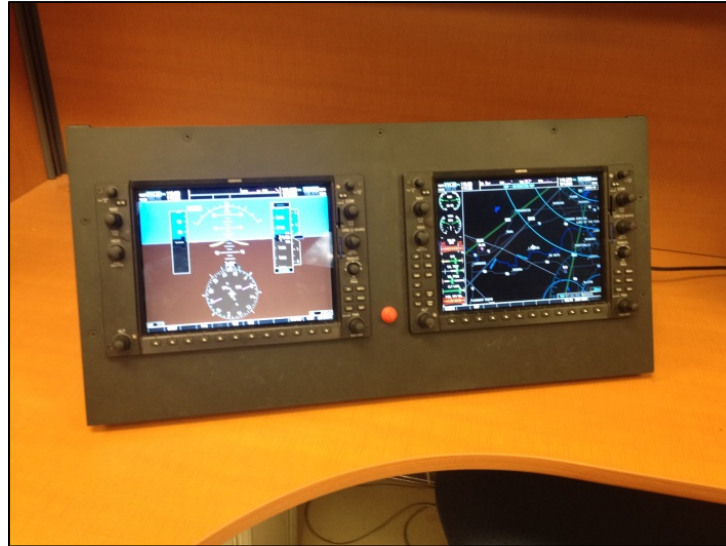
Figure 5.2 Aperçu final du socle G1000
