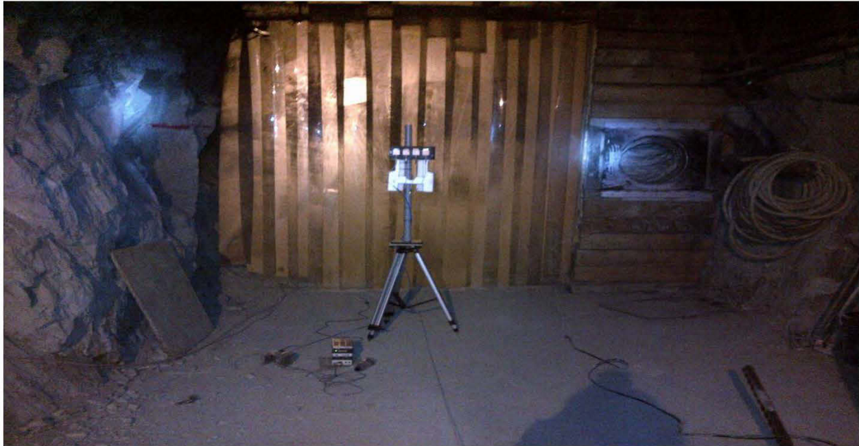
Figure 3.10: Système de transmission MIMO utilisant les ULA conventionnels
