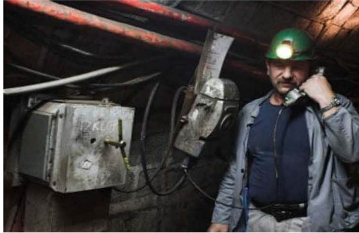
Figure 1.2: Système de communication filaire traditionnellement utilisés dans les mines souterraines
