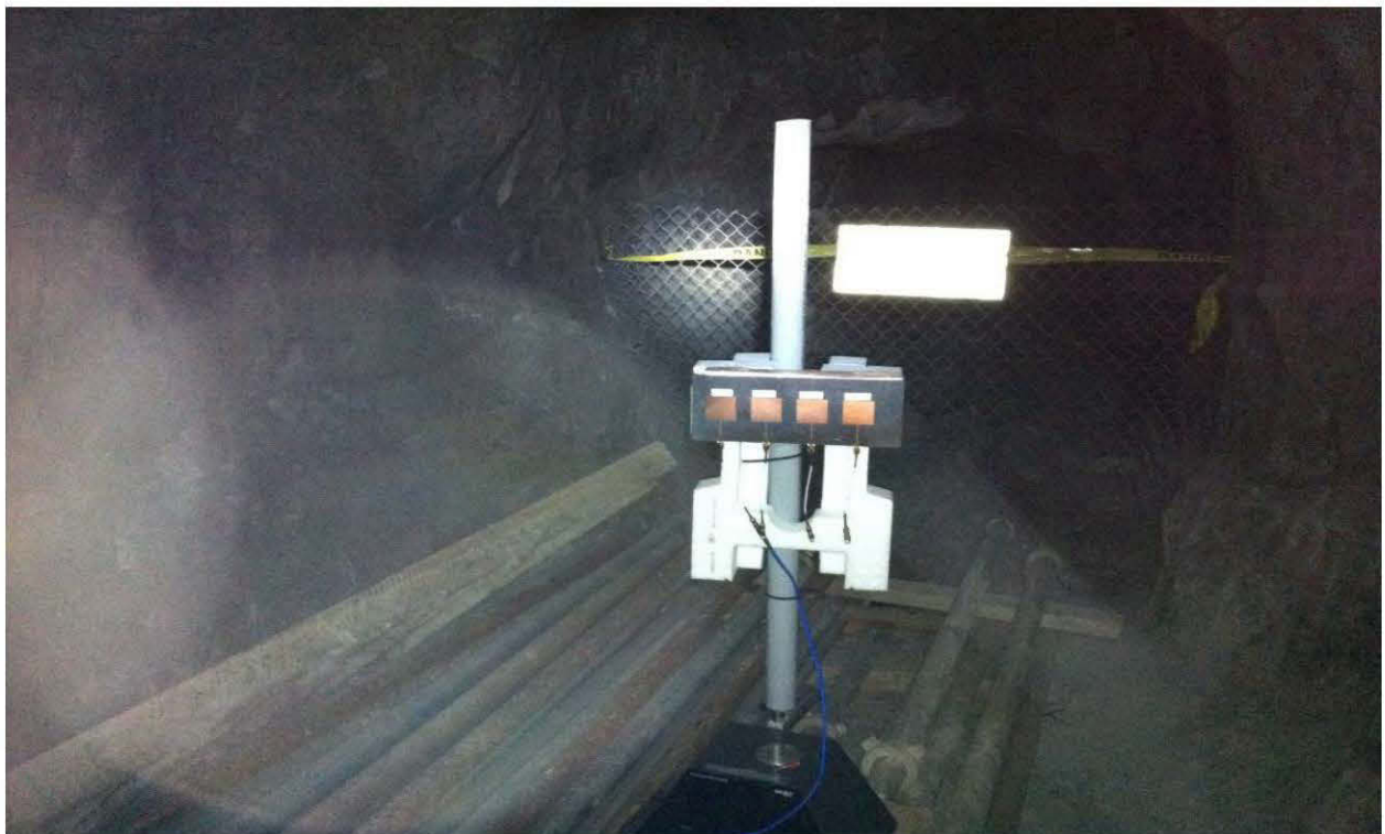
Figure 4.6: Émetteur MIMO conventionnel en position fixe dans une ramification à l'intérieur de la galerie minière, lors des mesures en NLOS
