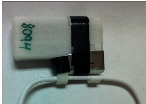
Figure 1.6 Le capteur de courant dans son boîtier
