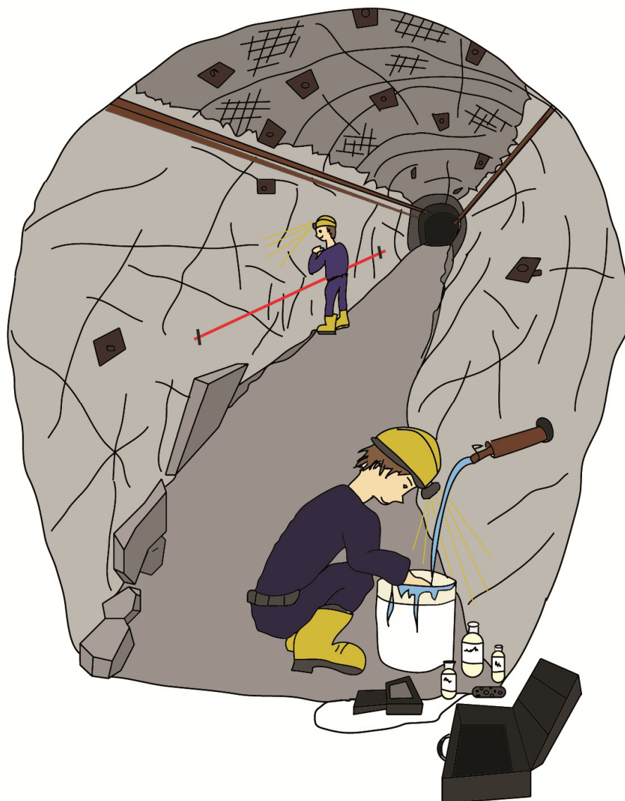
Figure 1.2: Illustration de l'échantillonnage des fractures (ligne de levé) et de l'eau (sonde et échantillons pour les analyses hydrogéochimiques) dans une galerie de mine
