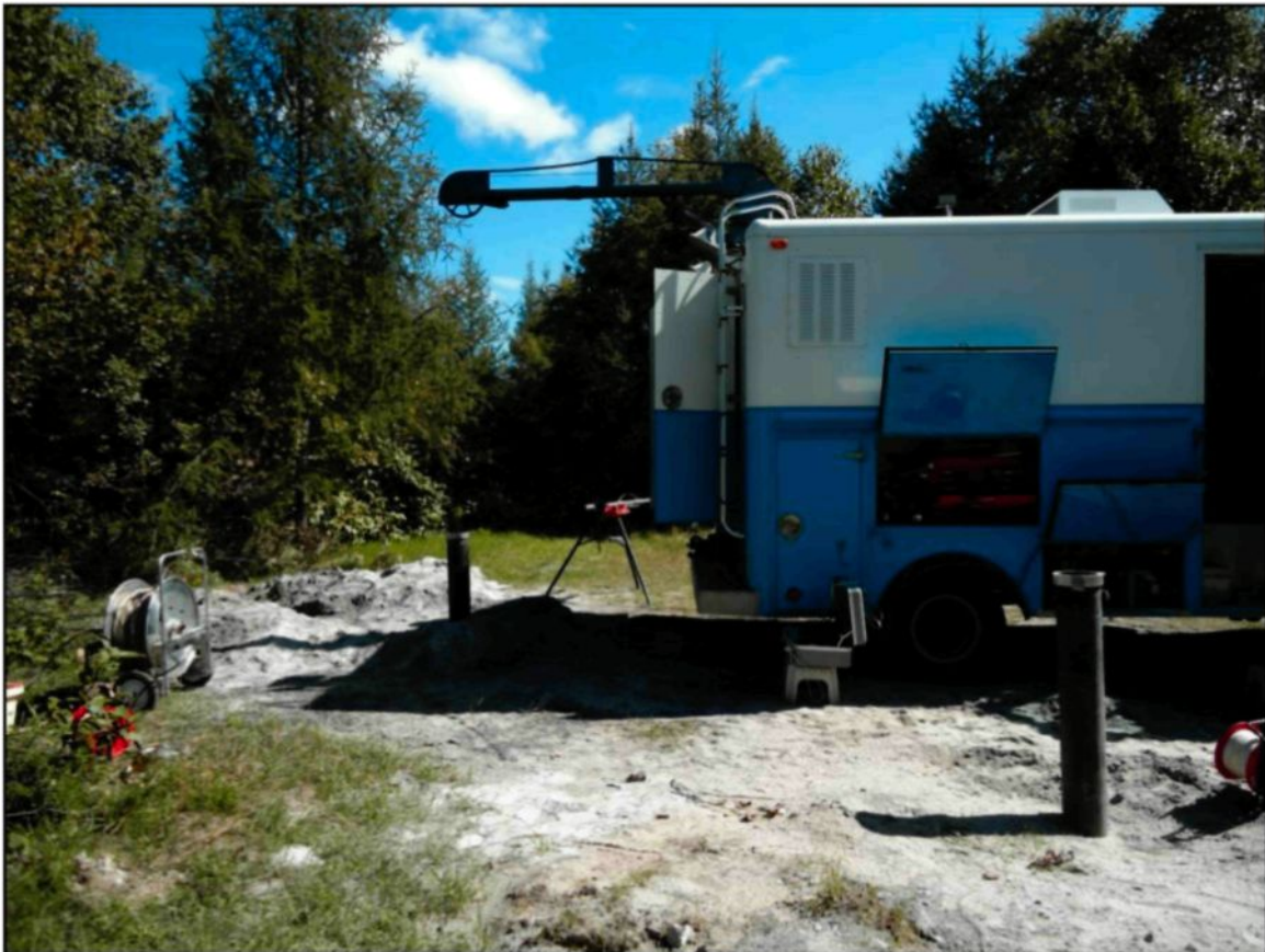
Figure 5-3 : Équipements pour les diagraphies en forage. Camion équipé d'un treuil et d'un câble d'acier permettant de descendre les sondes dans le forage (Photo prise le 8 septembre 2011 au site de Vauvert).
