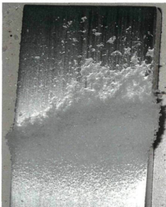
Figure 32 : Poutre d'aluminium après délestage à -13 °C
