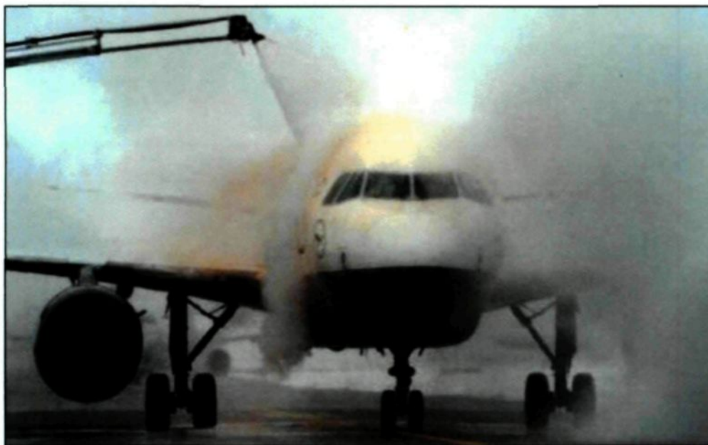
Figure 4 : Application du fluide dégivrant sur un avion de ligne avant le décollage
