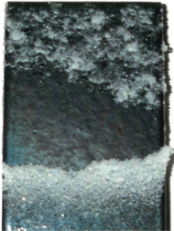
Figure 37 : Poutre de Wearlon® après délestage à -15 °C
