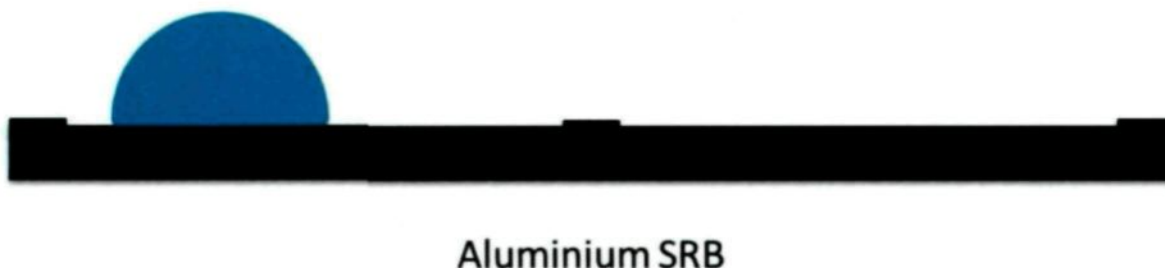
Figure 44 : Représentation d'une gouttelette d'eau à la surface de l'aluminium pour les essais en soufflerie réfrigérée
