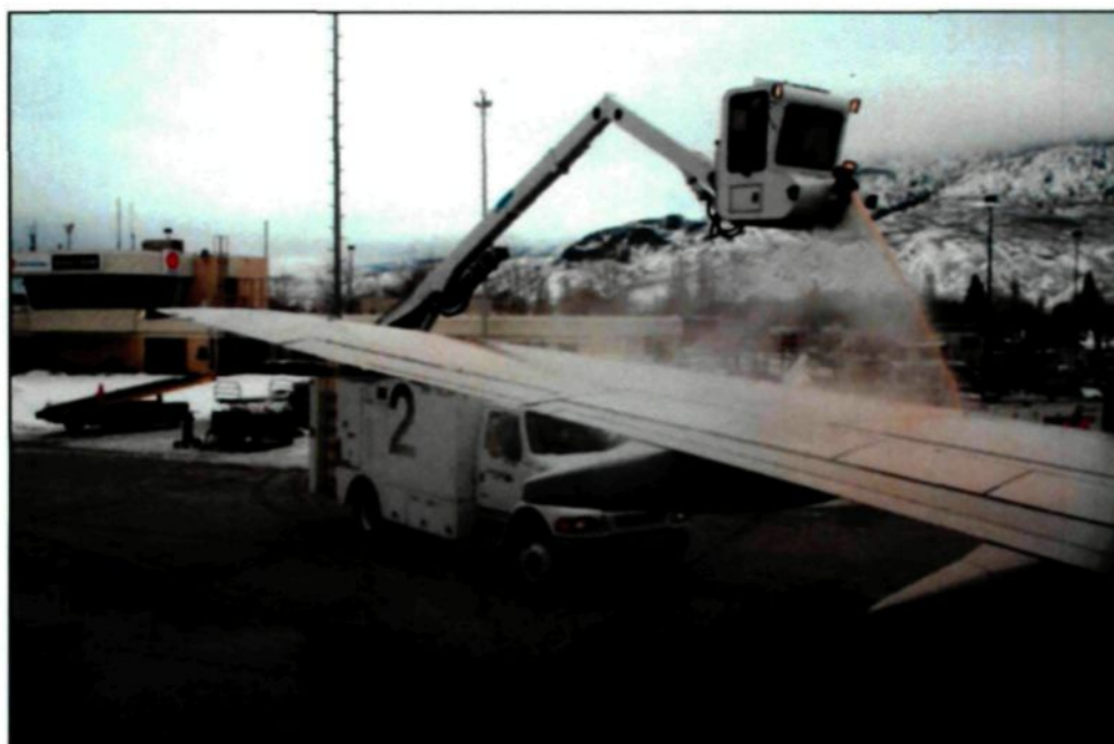
Figure 5 : Application d'un produit antigivre avant le décollage sur le fuselage et les ailes d'un avion de ligne
