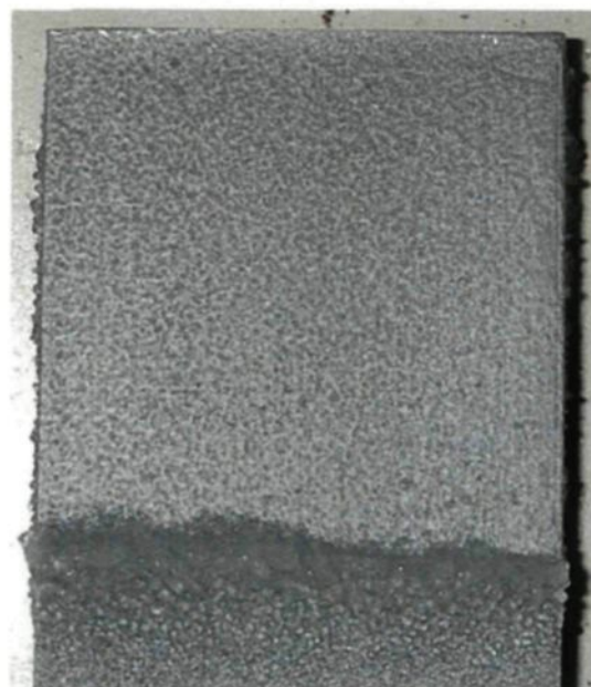
Figure 30 : Poutre d'aluminium gravé après délestage à -10 °C
