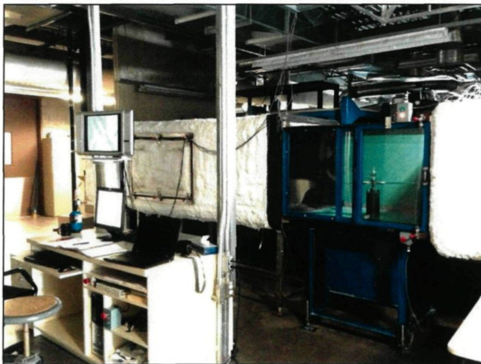
Figure 55 : Section d'essais de la soufflerie réfrigérée
