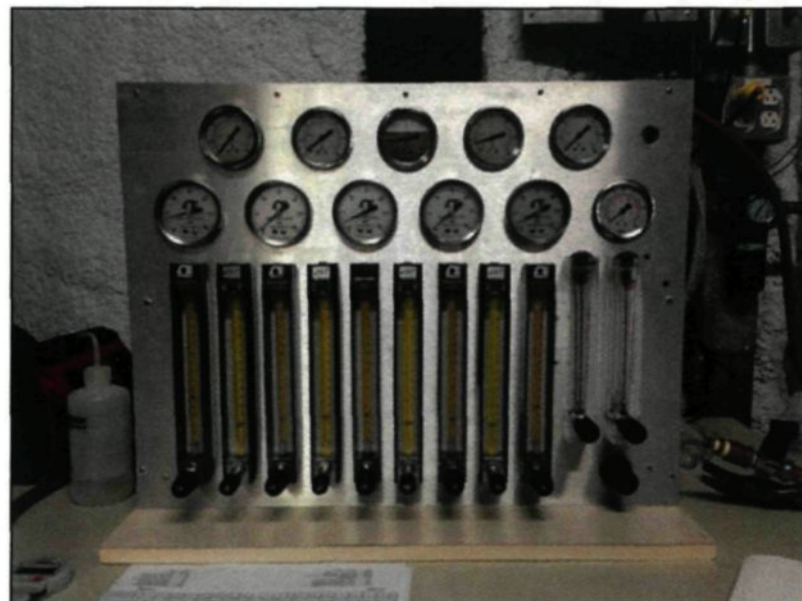
Figure 54 : Débitmètres contrôlant les gicleurs de la soufflerie réfrigérée
