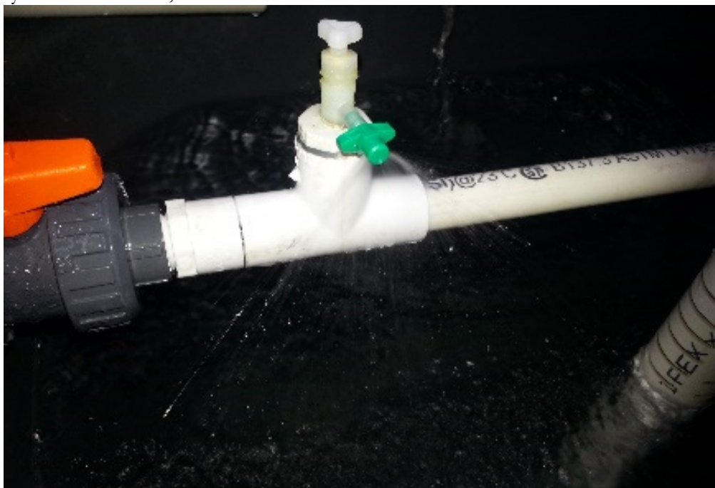
Figure 37 : Buse à microjet d'eau de 90° au-dessus de la surface d'eau permettant d'émulsifier le film d'huile de surface
