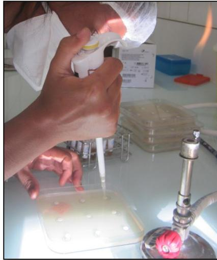
*Photo 34 : dépôt des extraits sur les disques*
