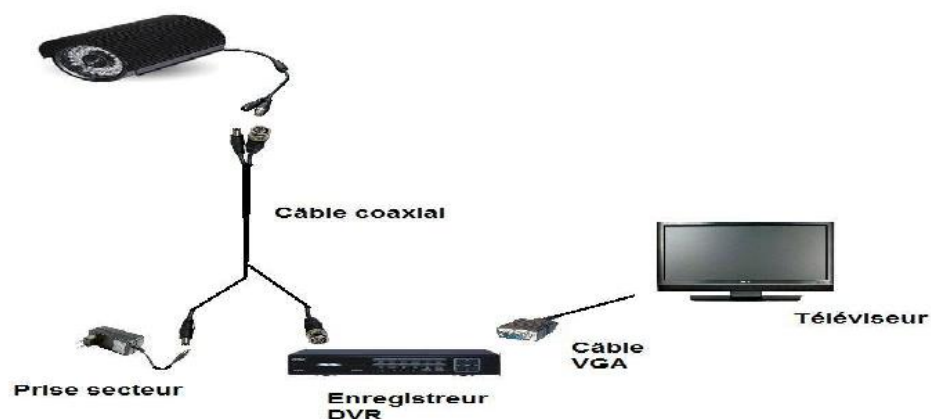
Figure -9- Système de télésurveillance filaire (câble coaxial)
