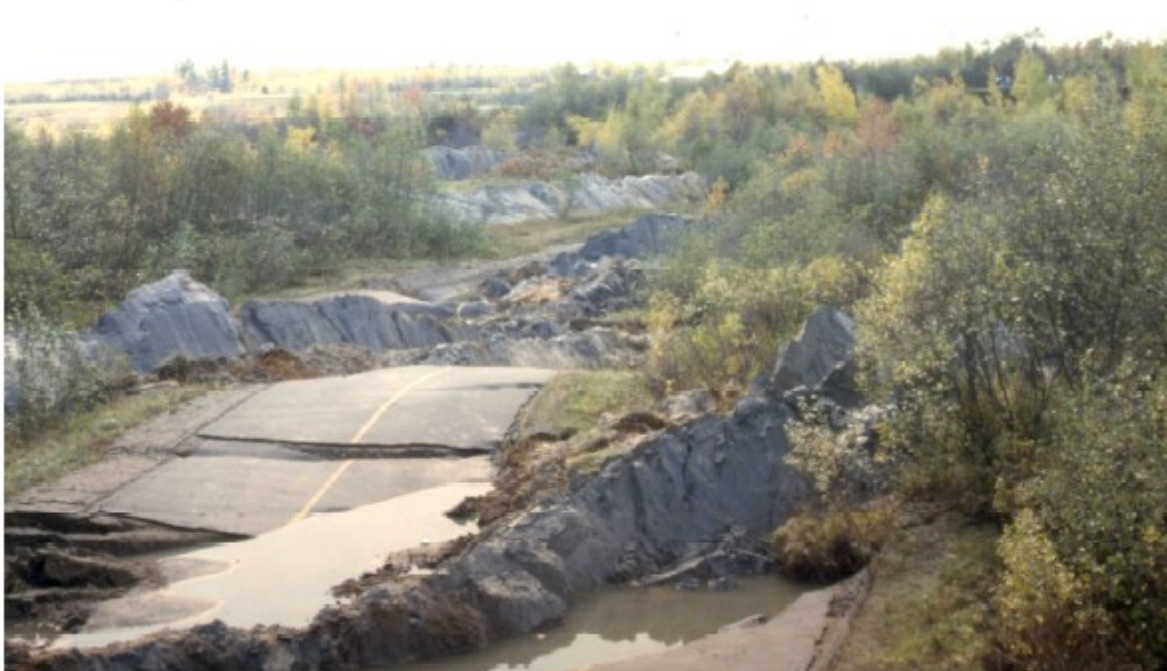
Figure 5-2 : Photographie montrant des horsts et grabens dans les débris de l'étalement de Saint-Luc-de-Vincennes. La photographie montre des morceaux de la route et des arbres toujours debout sur le sommet des grabens séparés par des horsts (source : MTMDET). À partir de (Locat et al. 2013a).
