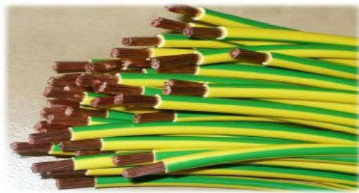
Figure 1.6: Opération de dénudage
