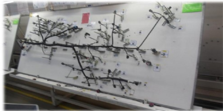
Figure 1.8: Tableau d'assemblage d'une ligne Carrousel
