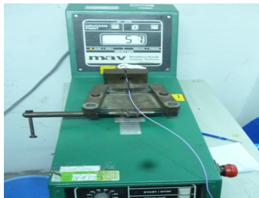
Figure 63: Essai de tenue de fils dans le connecteur C1E107-E
