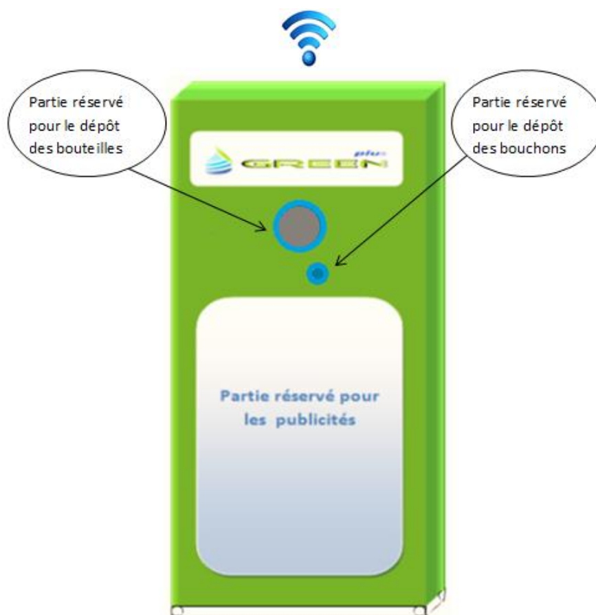
Figure 3.6: La machine de collecte des bouteilles en plastique 12
