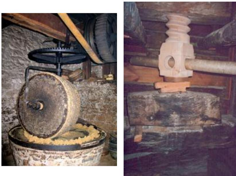
Fig9 : Méthode d’extraction d’huile végétale par presse à vis
