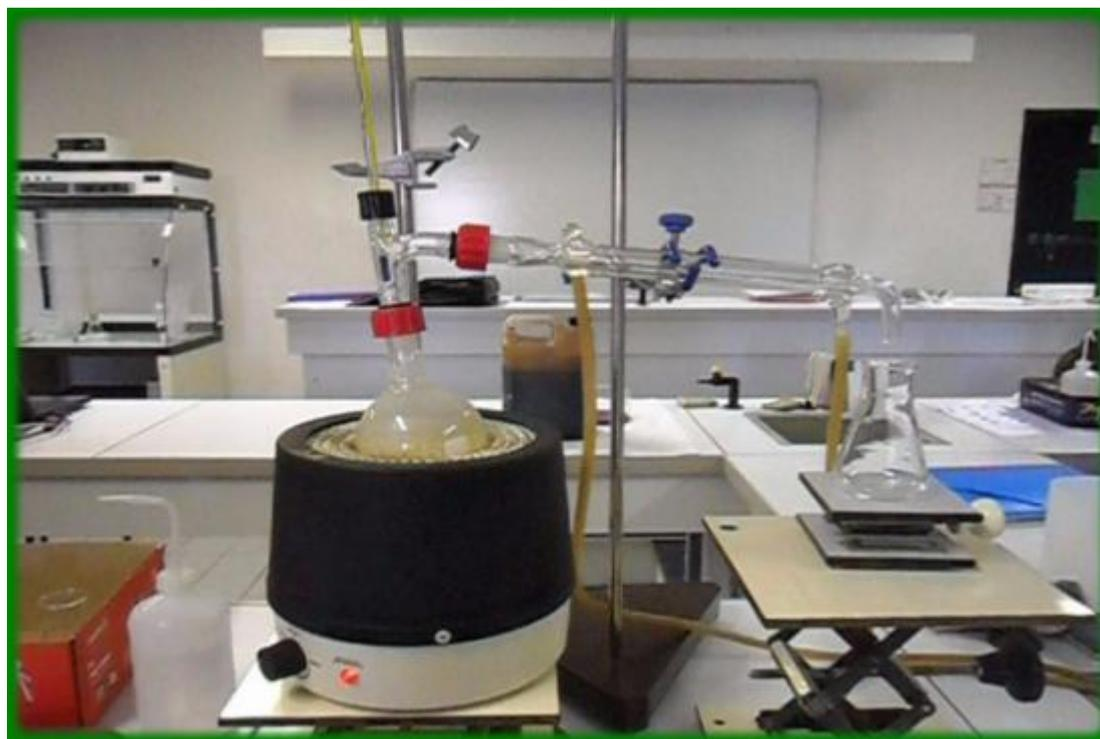
Figure 5: Image d'un distillateur par hydrodistillateur
