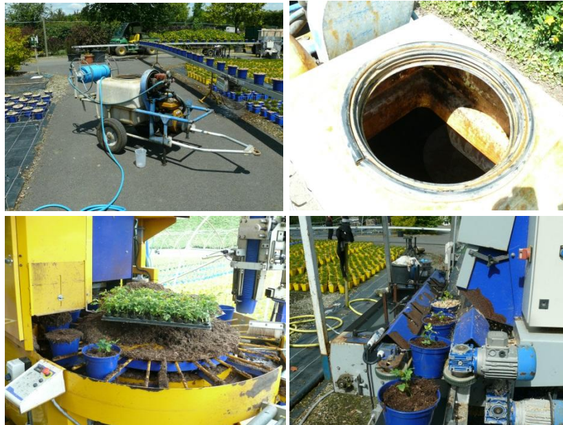
Figure 26 : Cuve utilisée pour l'inoculation (en haut) et chaîne de rempotage (en bas) avec mise en place du plant (à gauche) et de ses copeaux de bois (à droite):
