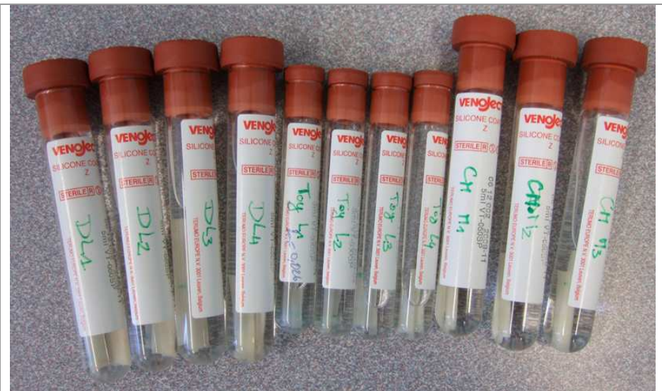
Figure 14 : Tubes à essai numérotés contenant les échantillons dans la solution saline à 0,9%
