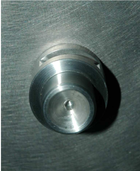
Figure 18: Photographie de la pièce d'adaptation pour appliquer la force de compression sur la tête fémorale.
