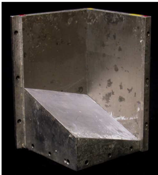
Figure 9: Photographie de la boîte conçue pour un fémur droit. Deux des quatre parois amovibles ont été retirées pour visualiser l'inclinaison du fond de la boîte.
