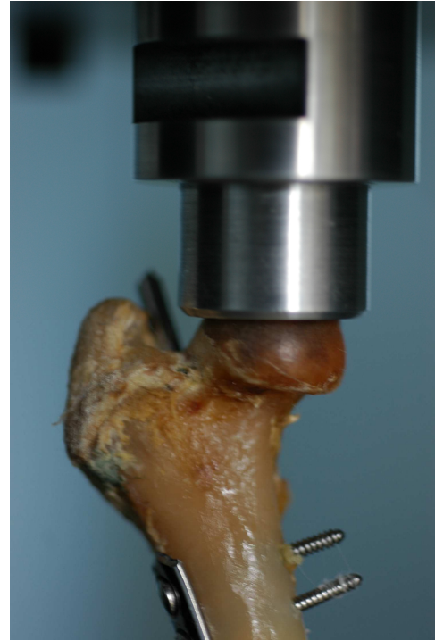
Figure 18: Photographie de la pièce d'adaptation pour appliquer la force de compression sur la tête fémorale.
