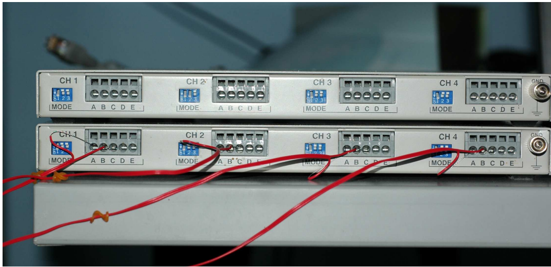
Figure 23: Photographie du pont de jauges lors de l'acquisition des données de déformations des 4 jauges d'extensométrie.
