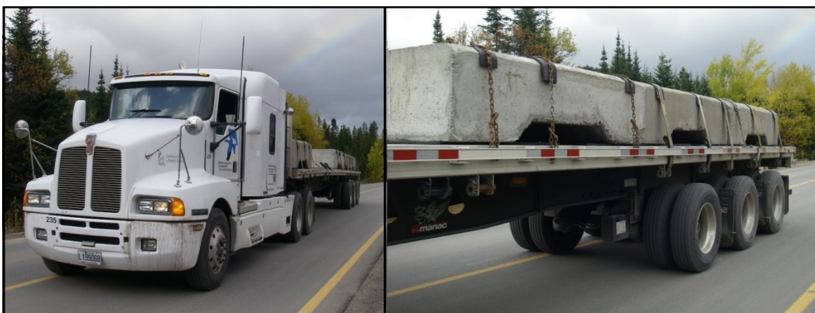
Figure 3.8 : Camion avec remorque tridem chargée avec des blocs de béton
