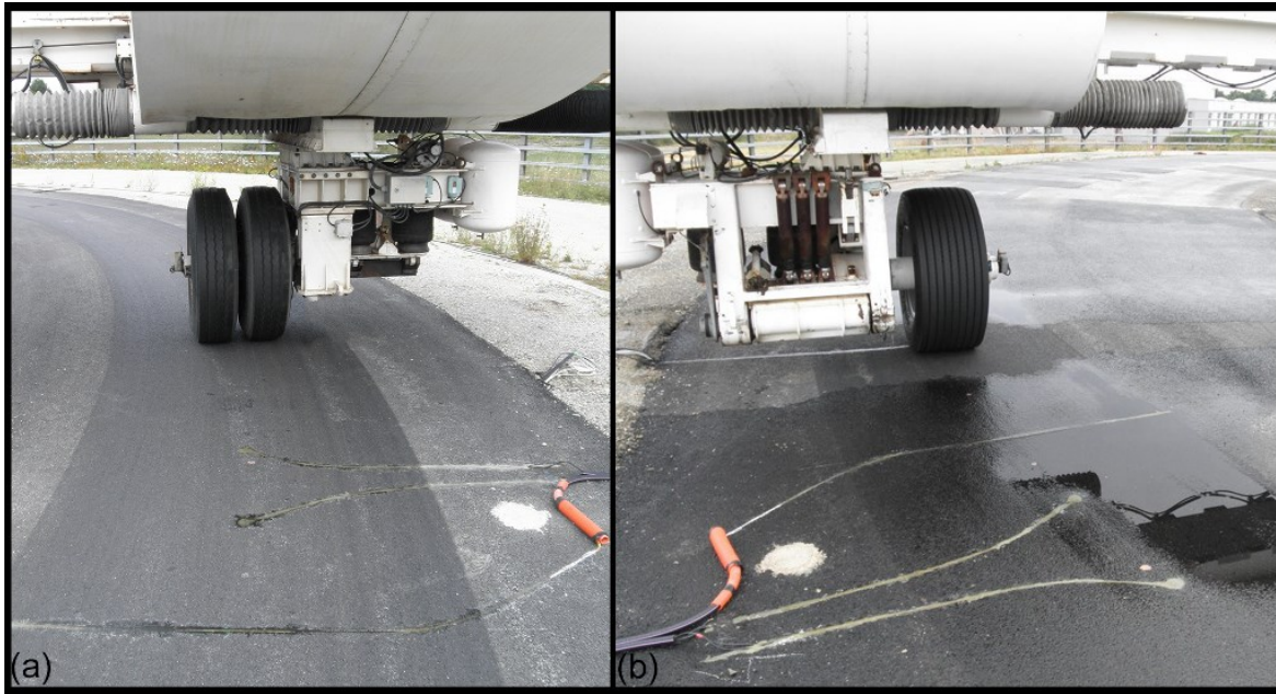
Figure 3.16 : Modules du manège de fatigue équipés avec (a) un pneu jumelé 12.00R20 et (b) un pneu à bande large 455/55R22.5
