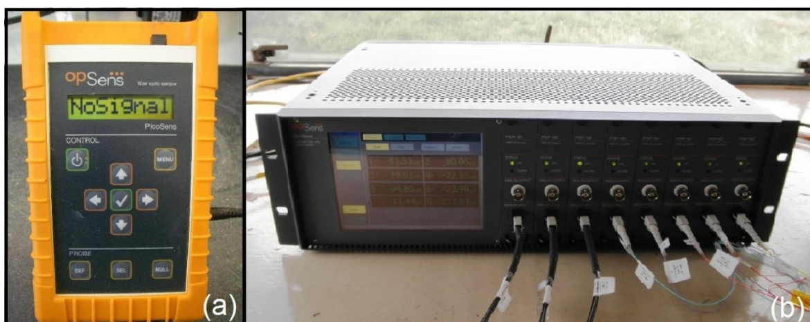
Figure 4.6 : Conditionneur de signal : (a) modèle PicoSens, (b) modèle RadSens
