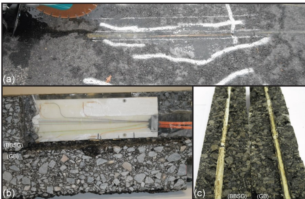
Figure 4.16 : Extraction des plaques de déformation : (a) découpe d'un bloc contenant les plaques (section B), (b) extraction (section A), (c) interface des couches (section A)
