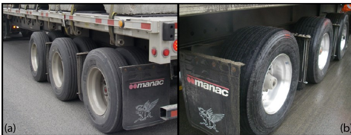
Figure 3.9 : Tridem équipé de (a) pneus jumelés 11R22.5 et (b) de pneus à bande large 455/55R22.5
