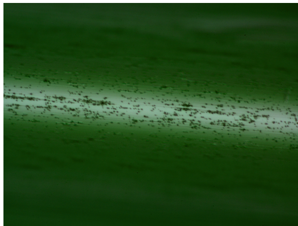
FIGURE 4.25 – Résultat de fibrage d'une tige de verre de silice - aluminium dopé avec 10% mol de Tb_2O_3 : TSA10
