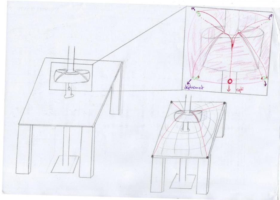
Séance du 27 mars, nous décidons de réaliser ce prototype. A l'aide d'une bâche de 3x2mètres possédant des œillets, de ficelle, de scotch, nous essayons de ranger la bâche dans une boîte en carton 17 x 28 x 38 cm. Sur la première solution testée, nous avons seulement accroché les coins de la bâche. Ainsi en tirant sur les coins à l'aide de la ficelle, il restait de la bâche non rangée au
