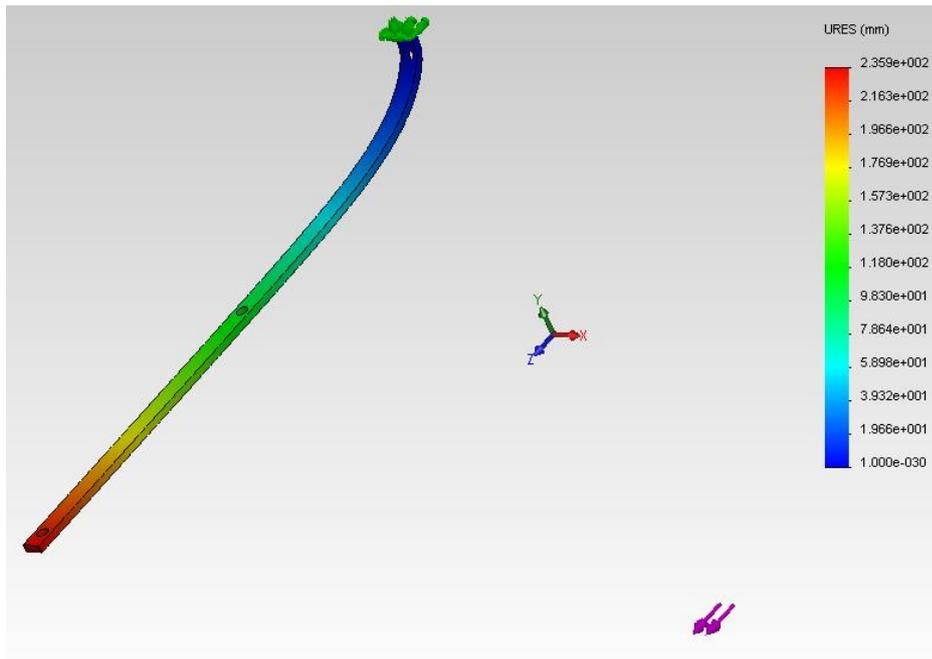
Il y a un déplacement maximal de 23.6 cm dans les conditions maximales. On en déduit qu'il faut soit diminuer nos contraintes (baisser la vitesse du vent), soit choisir un matériau plus résistant soit modifier la structure pour diminuer les efforts assimilés à l'encastrement.
