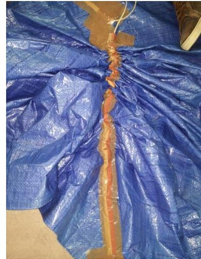
Finalement après un essai avec un câble plus résistant et de la gaine sur les quatre diagonales, un nouveau problème survient c'est que cet ensemble de scotch qui forment la gaine devient trop difficile à plier une fois qui s'accumule au niveau de la boîte. Cette solution ne fonctionne donc pas. Un nouvel essai est tenté en supprimant certaines parties de la gaine pour ne plus en laisser que 10 centimètres tous les 30 centimètres. Cela ne fonctionne pas bien non plus.
