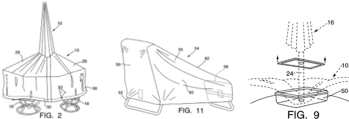
C'est la figure 9 qui nous a tout de suite interpellée. On y voit une boîte traversée en son centre par le parasol et d'où s'extirpe une protection souple. La ressemblance avec notre projet est évidente, il nous fallait donc approfondir la lecture du brevet pour déterminer le risque que présente cette technologie sur la brevetabilité de notre projet.
