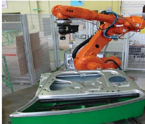
Figure 30 : Sertissage robotisé
