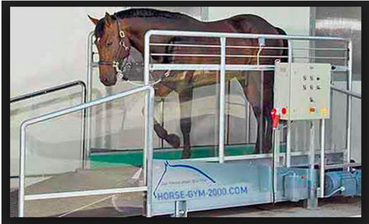
Figure 33: Photographie d'un tapis roulant pour équidés très utile lors de la réhabilitation du cheval fracturé
