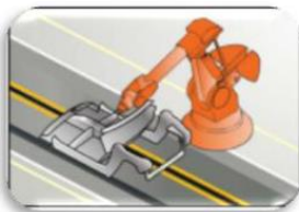
Assemblage de l'armature
