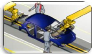
Pose du bard-brise
