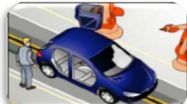
Montage des portes
