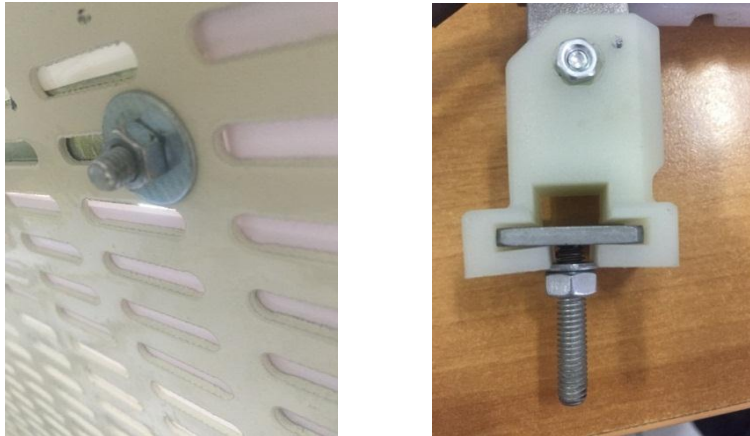
Figure 130: Système de fixation des composants sur la table perforée
