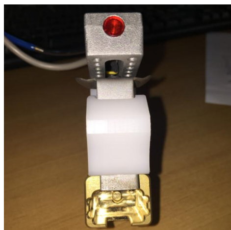
Figure 73: Contrepartie agrafe réel avec blocage pneumatique
