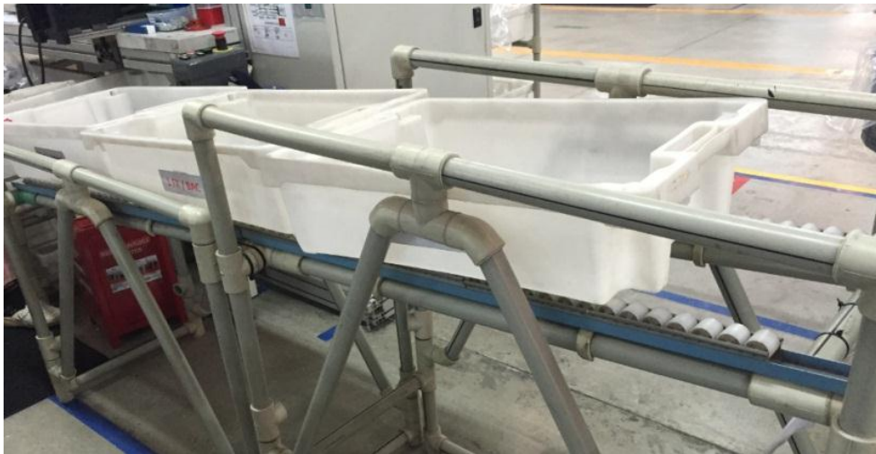
Figure 98 : Convoyeur adopté dans des autres applications
