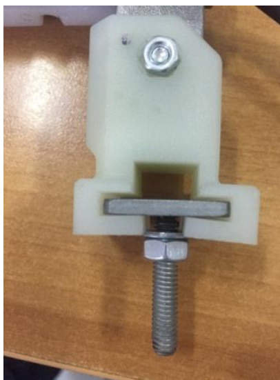
Figure 69: Outil de fixation des contreparties avec la table perforée
