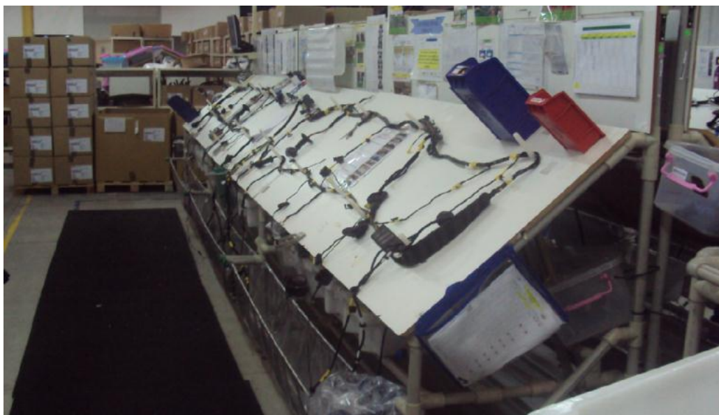
Figure 23 : Poste de contrôle final
