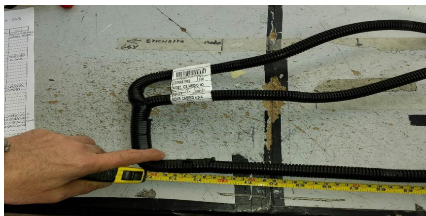
Figure 27: Méthode classique de mesure des dimensions par un double mètre
